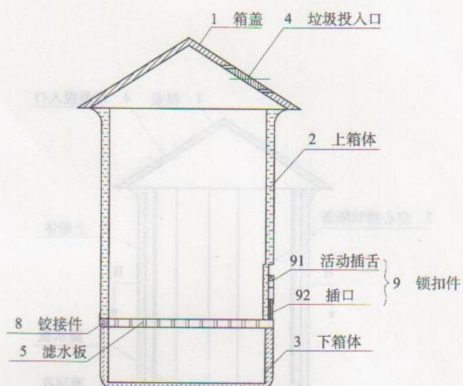
图 5 装垃圾状态 (通风结构略去)
