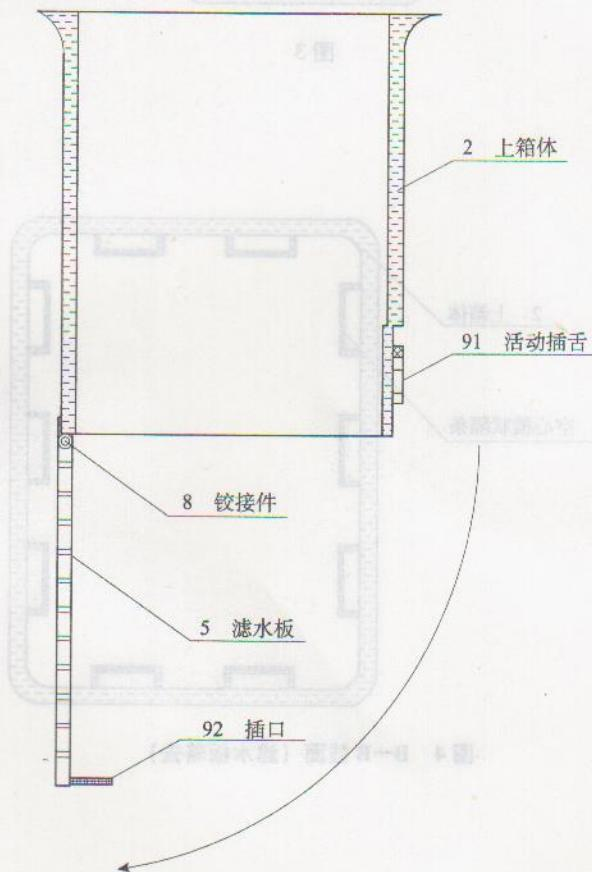
图 6 卸垃圾状态 (通风结构略去)
