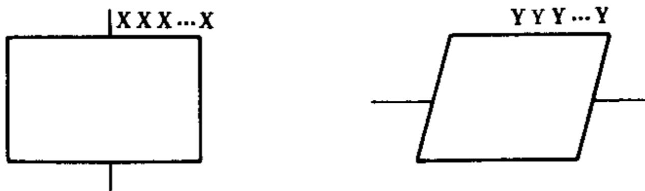
在系统流程图中，一个描绘数据媒体的符号在很多情况下既可以表示输出媒体又可以表示输入媒体。表示输出媒体的流程图说明性文字要写在符号的右上角。表示输入媒体的符号的流程图说明性文字要写在符号的右下角。
