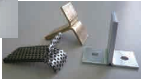
▶ 各種金属を割裂加工技術によりT字型に加工
