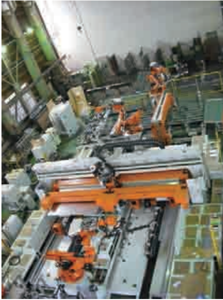
▶ 高性能材料突合せ機構を採用したレーザー溶接システム
