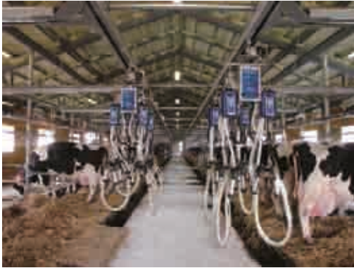
▶ 搾乳ユニット自動搬送システム “キャリロボ”
