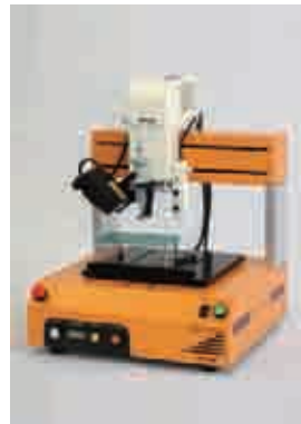
▶ クリーム半田塗布門型ロボット
