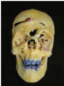
▶ 食塩を用いた医療用積層造形モデル ソニーイーエムシーエス（株）との共同開発品 （徳島大学医学部形成外科学提供）
