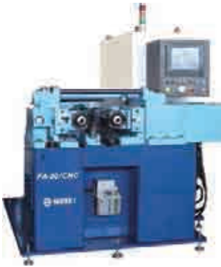
▶FA-20/CNC：自動車用歯車向けCNC転造機
