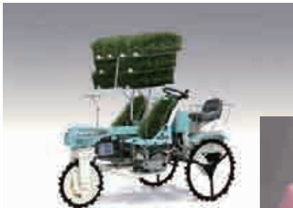
▶ポット成苗田植機兼用4条植え HST変速で高速・高精度・高能率のポット 成苗田植機
