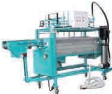
▶ HFURC-3S型 葉付き大根洗浄機
