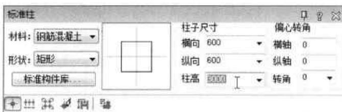
图16-35 设置标准柱参数值
