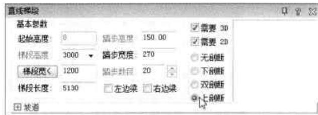
图16-98 设置直线梯段参数
