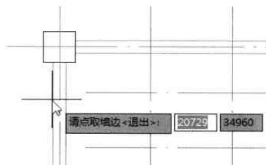
图 16-44 选取墙边线
