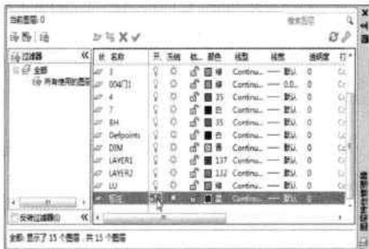
图3-23 关闭“标注”图层
