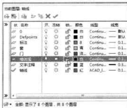
图3-27 锁定“墙体线”图层
